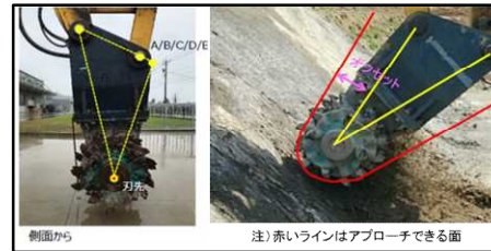
アタッチメントの形状設定を試行・検証し 出来形精度を改善 【(株)豊蔵組】
