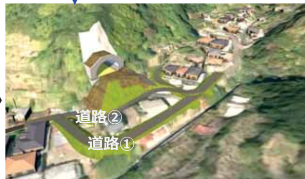
3) 橋台の施工に備え、再度、現道を切り回し
