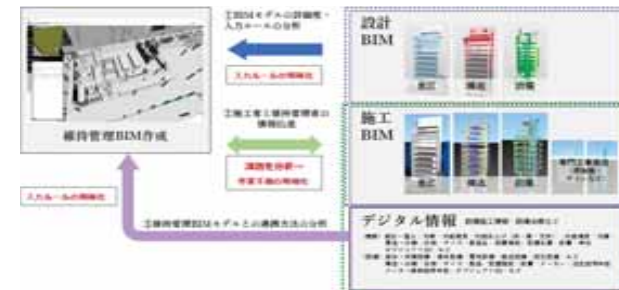
施工者による、設計BIM・施工BIMと連携した維持管理BIMの作成
